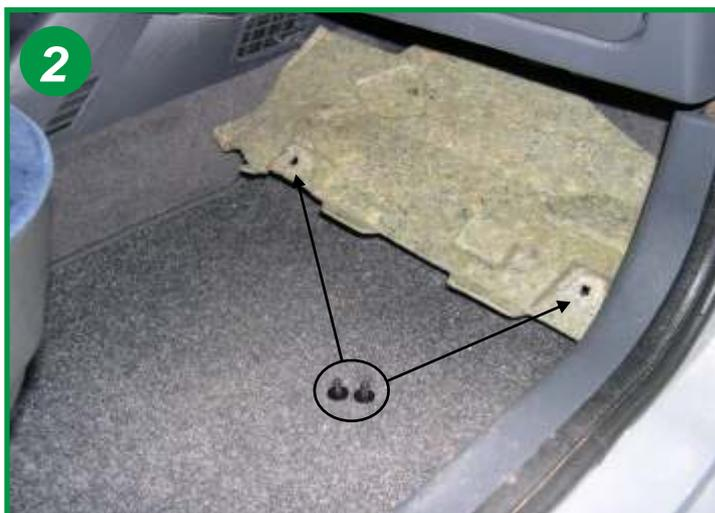
Retirer les deux goupilles plastiques (2) et abaisser le cache sous la boîte à gants, il n'est pas nécessaire de le retirer totalement.
