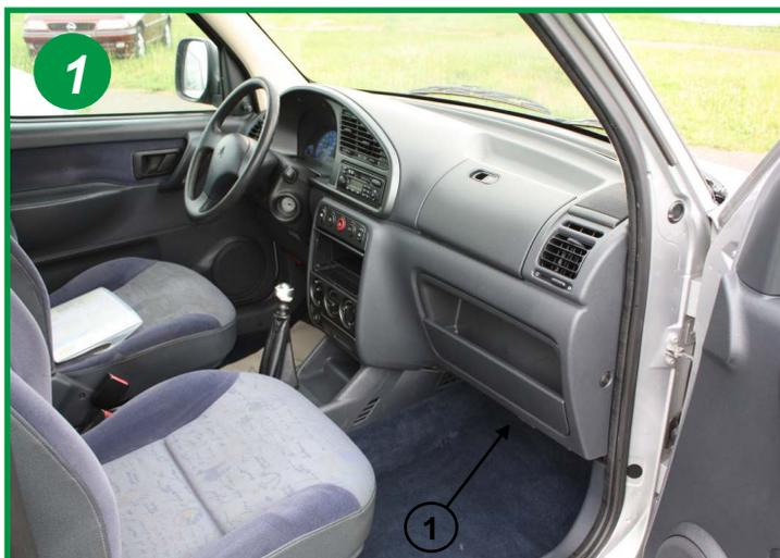
L'élément filtrant est situé dans l'habitacle du véhicule coté passager sous la boîte à gants (voir flèche 1)..
