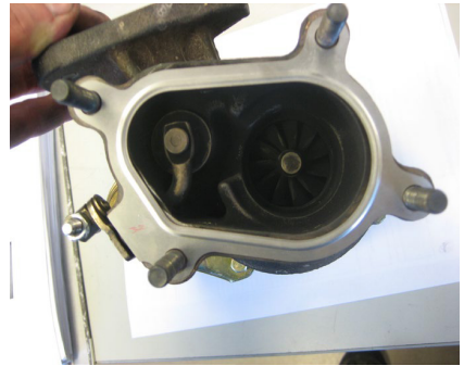
Junta montada corretamente
