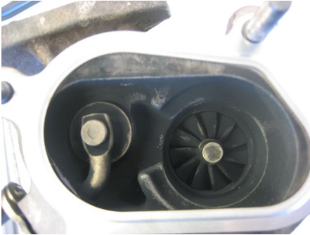
Nesprávně namontované těsnění
