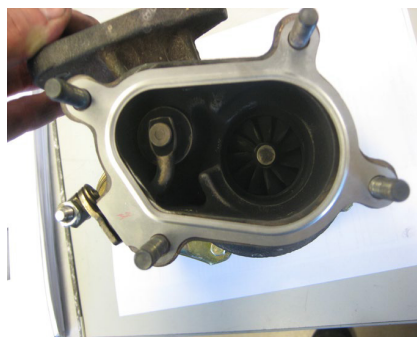
Megfelelően felszerelt tömítés
