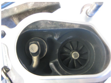
Garnitură montată incorect
