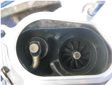
Junta montada incorretamente
