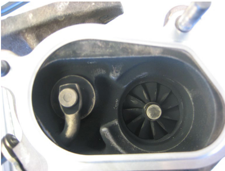
Pakning forkert monteret
