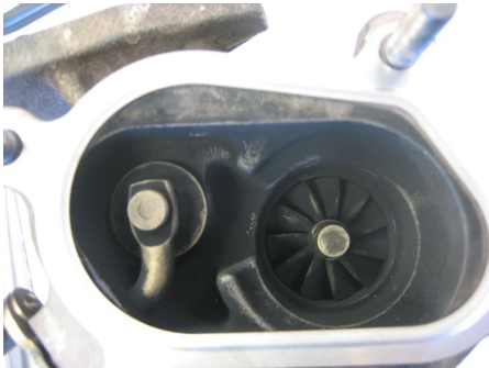
Falsch eingebaute Dichtung
