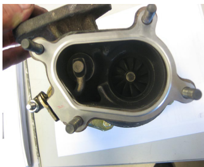
Garnitură montată corect
