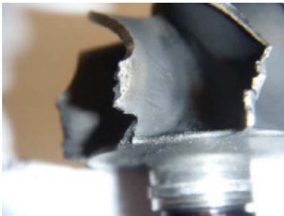
Poškodovana izpušna turbina
