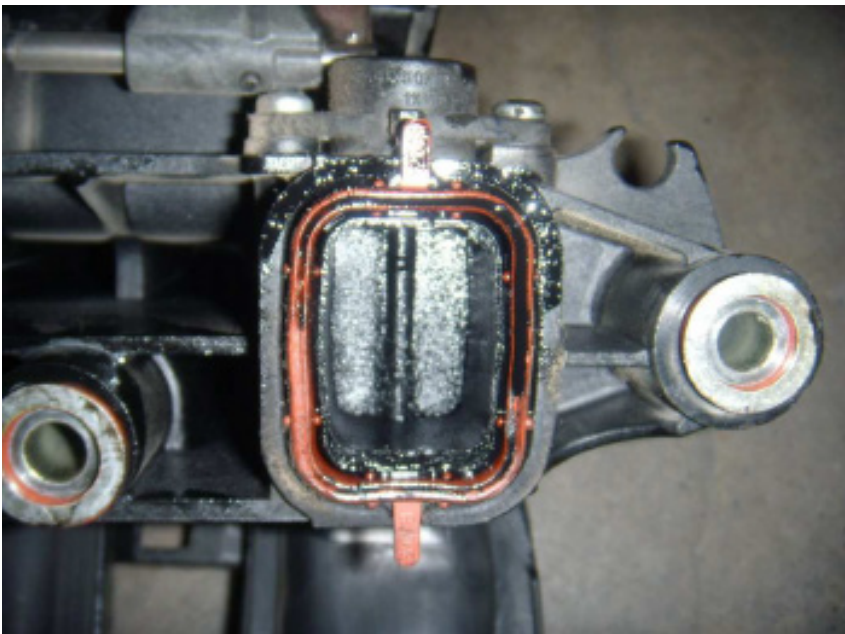
Luftansaugrohr aus Plastik mit zusätzlicher Turbulenzverschlussklappe
