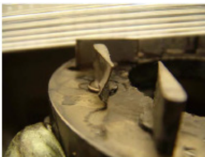
Alabes de tobera dañadas
