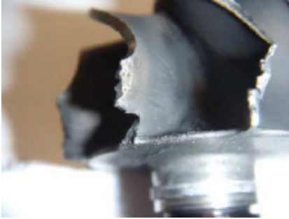
Poškozená výfuková turbína
