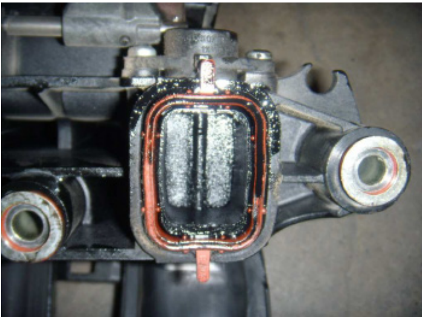
Collettore di aspirazione dell'aria di plastica, con la lamella di turbolenza addizionale
