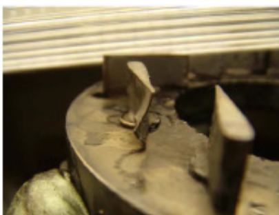
Uszkodzone łopatkę dyszy
