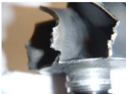
Turbina de escape dañada
