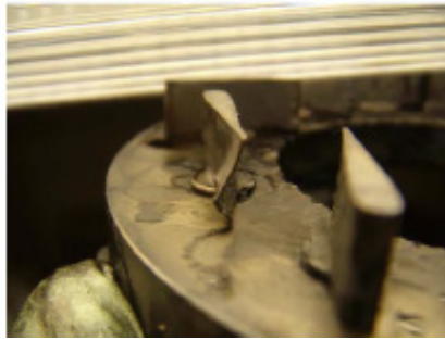
Lamele duzei deteriorate
