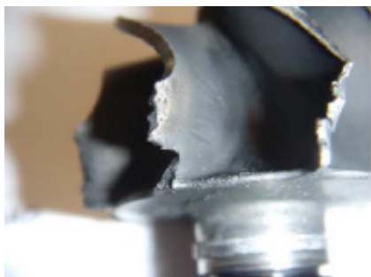
Uszkodzona turbina wydechowa
