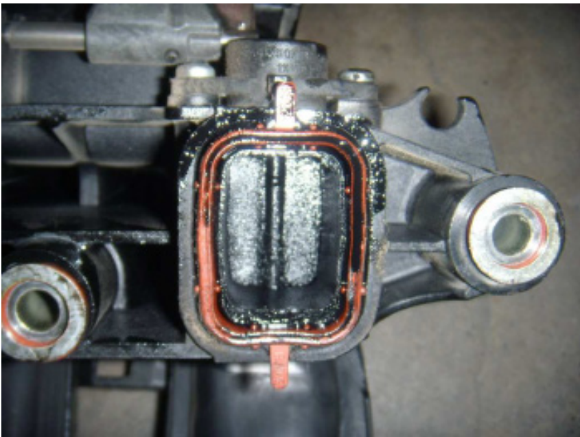
Luftindtagsmanifold af plast med ekstra hvirvelklap
