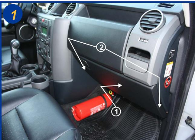
Le filtre d'habitacle est situé à l'intérieur du véhicule, côté passager derrière la boîte à gants (1). Ouvrir la boîte à gants et repérer les 2 tirants de retenue du tiroir de chaque côté (2).
