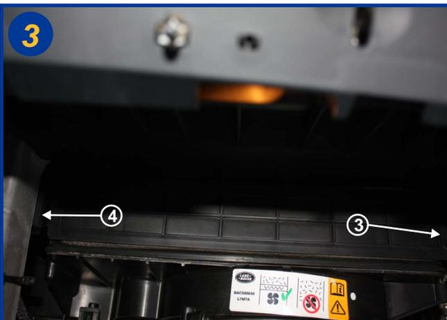
Ouvrir le couvercle du boîtier filtrant en actionnant la patte de fermeture à droite (3). Ouvrir celui-ci en prenant garde à la charnière à l'autre extrémité (4).
