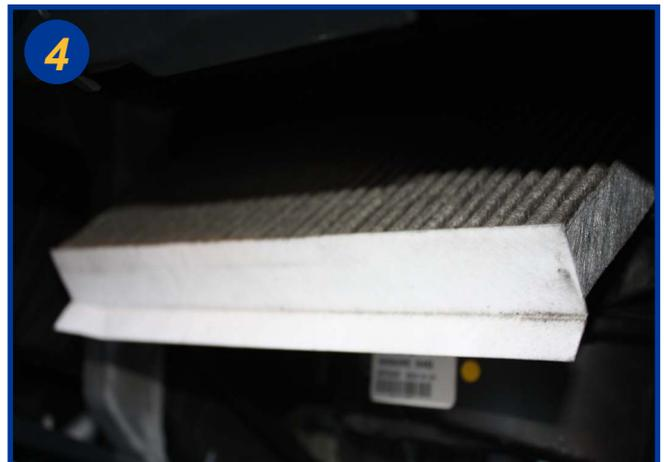
Extraire l'élément filtrant usagé et procéder à son remplacement, engager le nouveau filtre dans son logement et le maintenir en haut afin de replacer le couvercle. Le remontage s'effectue dans l'ordre inverse du démontage.
