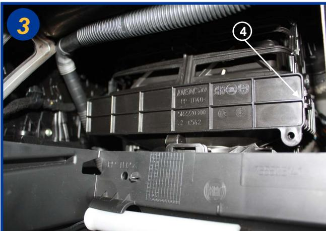
Ouvrir le boîtier filtrant en actionnant le fermetur situé sur la droite (4), le couvercle est articulé à gauche. Extraire le couvercle.
