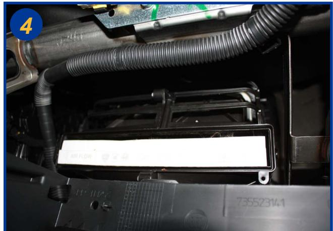
Sortir l'élément filtrant usagé et procéder à son remplacement.
