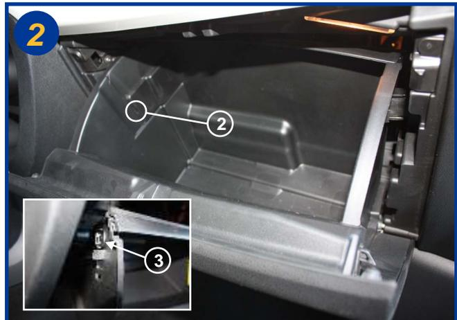
Retirer les butées de boîte en engageant un tournevis dans le trou prévu (2). Répéter cette action à droite également, puis dégager la pièce plastique (3) attention à la détente de l'élastique. Basculer la boîte à gants vers le bas.
