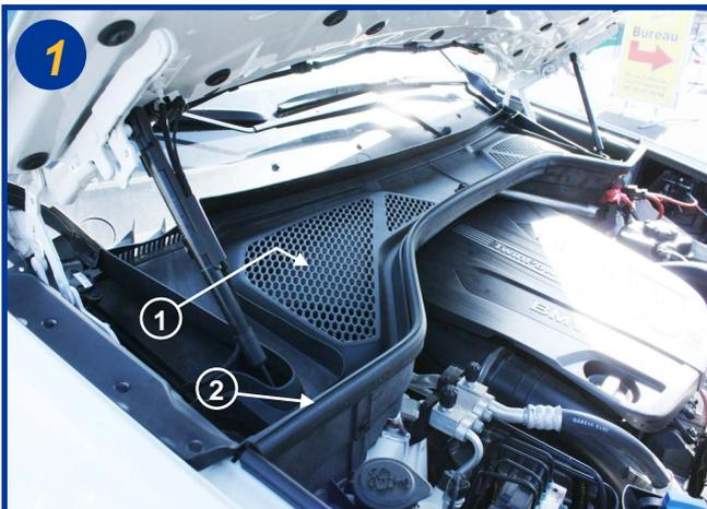
Les filtres d'habitacle sont situés sous le capot moteur, coté passager devant la baie de pare-brise (1). Ouvrir le capot moteur et retirer sur la moitié le joint d'étanchéité du compartiment moteur (2).
