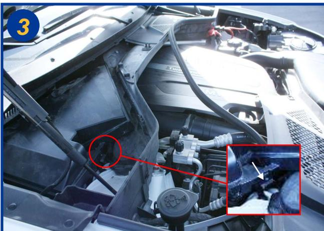
Soulever le loquet de fermeture et dégager le boîtier filtrant en le soulevant légèrement, puis le sortir dans sa totalité; les filtres se trouvant à l'envers.
