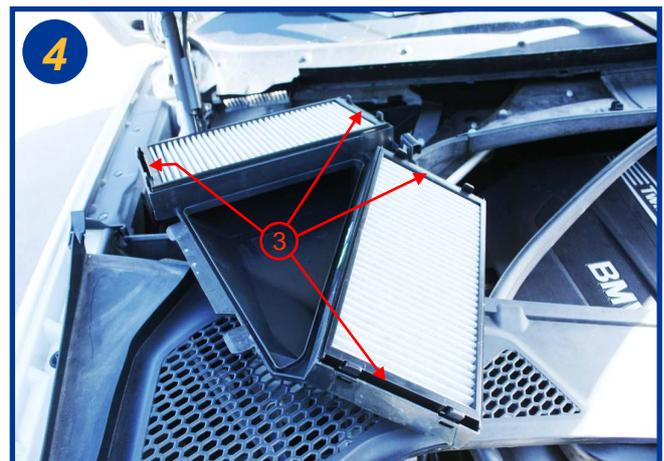
Actionner les pattes aux 2 extrémités de chaque filtre (3) afin de les sortir du boîtier. Remplacer les filtres. Le remontage s'effectue à l'inverse du démontage.
