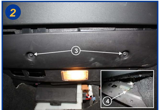
Dévisser ensuite les 2 vis torx T20 (3) et retirer le cache sous la boîte à gants, il est nécessaire de débrancher l'ampoule du plafonnier (4)(voir encadré).
