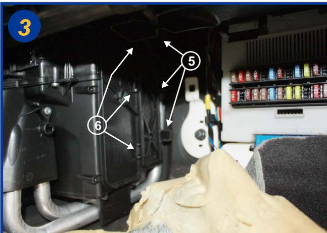
Ouvrir le boîtier filtrant en agissant sur les 3 pattes de fermeture (5) ôter ce couvercle qui est articulé sur le coté gauche (6).
