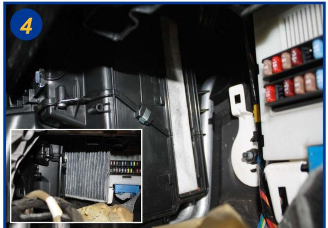
Extraire le filtre usagé en le déformant. Le remontage s'effectue dans le sens inverse du démontage.
