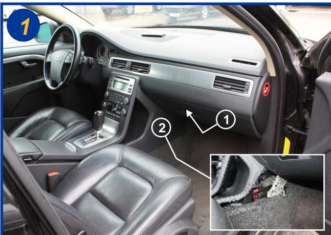
Le filtre d'habitacle est situé à l'intérieur du véhicule, coté passager sous la boîte à gants coté console (1). Exercer une pression sur le flanc de la console (2) pour la dégrafer et l'extraire totalement (voir encadré).
