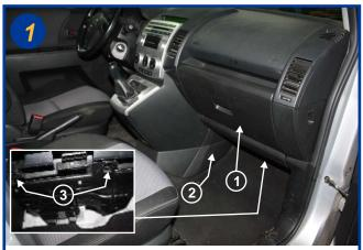
Les filtres d'habitacle au nombre de 2 sont situés coté passager sous la boîte à gants (1). Dégrafer le carter de la console centrale (2) en tirant dessus, puis le carter plastique sous la boîte à gants en manipulant les 2 fermoirs (3) (voir encadré).
