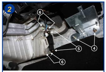
Dévisser les 2 écrous de 12 mm (4) et déplacer le support fusible vers la droite.
