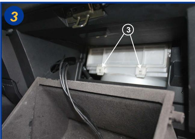
Ouvrir le boîtier filtrant en soulevant les 2 fermoirs (3) et retirer le couvercle.
