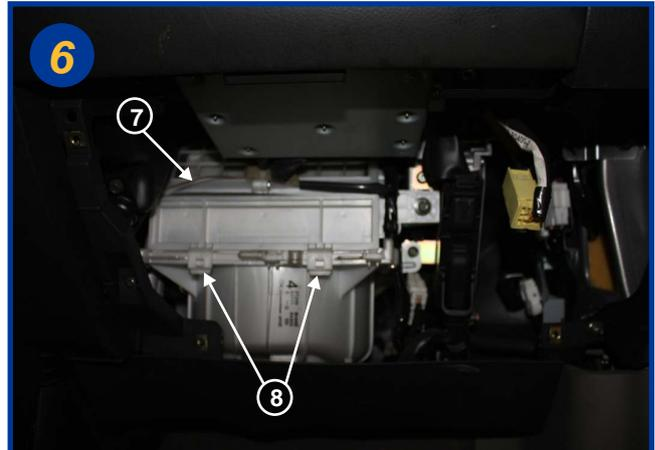
Ecarter la connectique (7) et ouvrir le boîtier filtrant en tirant sur les 2 fermetures (8) du couvercle.
