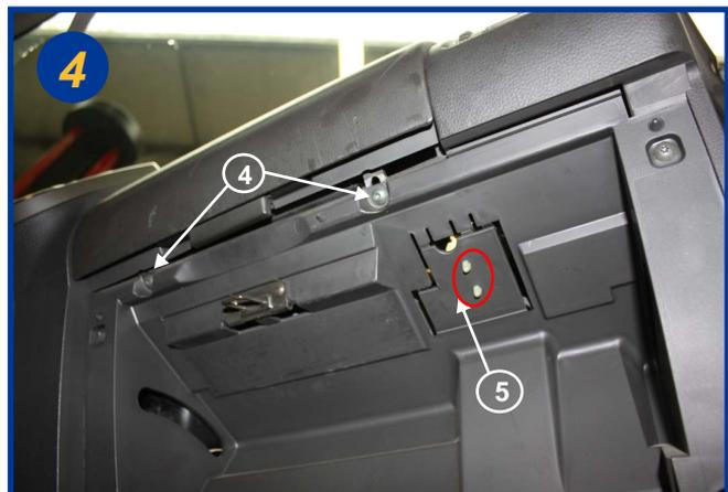
Dévisser les 2 vis torx (4), puis ouvrir la trappe (5) pour retirer le connecteur qui se trouve sur le couvercle de la trappe. (sur la photo le connecteur se trouve à l'endroit des 2 picots blancs)
