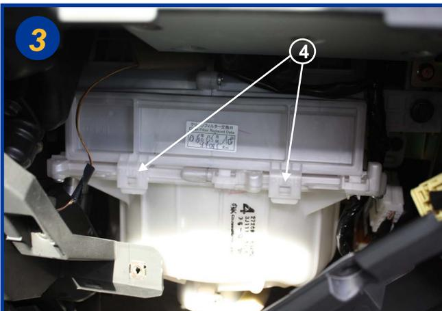
Retirer le couvercle du boîtier filtrant en agissant sur les 2 pattes (4).
