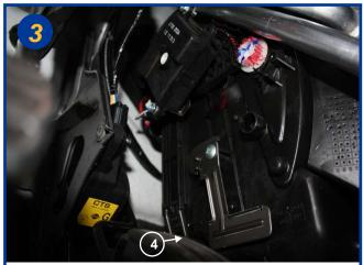
Dégager par le dessous le couvercle du boîtier filtrant (4) et le retirer totalement (il est nécessaire d'appuyer sur la pédale d'accélérateur pour dégager ce couvercle). Attention, il y a une encoche dans sa partie supérieure.
