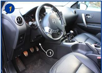
Le filtre d'habitacle est situé à l'intérieur du véhicule, coté conducteur derrière la console centrale (1).
