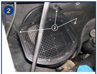
Ouvrir le boitier filtrant en actionnant les 3 fermetures et retirer ce boitier (voir flèche 2).
