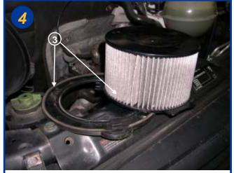
Dissocier l'élément filtrant de son support en pressant les deux clips plastiques situés sur la plaque support (voir flèche 3). Remplacer l'élément filtrant et le remontage s'effectue alors dans l'ordre inverse du démontage.
