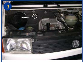
L'élément filtrant est situé sous le capot moteur dans la bouche d'aération coté passager (voir flèche 1). Ouvrir le capot moteur.
