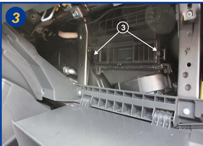
Appuyer sur les 2 pattes (3) aux extrémités du couvercle du boîtier filtrant et retirer le couvercle.
