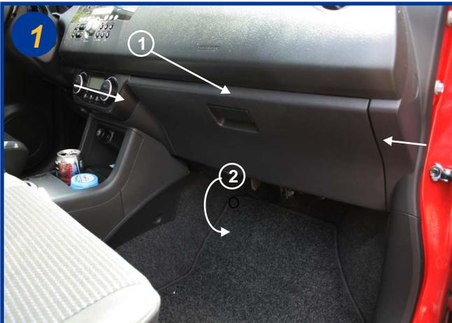
Le filtre d'habitacle est situé à l'intérieur du véhicule, coté passager derrière la boîte à gants (1). Ouvrir cette dernière (2) et presser sur les flancs du tiroir dans le sens des flèches pour dégager les butées arrêteurs.
