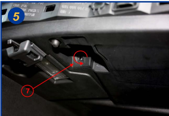
Dévisser la vis (7) à l'intérieur de la boîte à gants juste à côté du mécanisme de fermeture de la boîte
