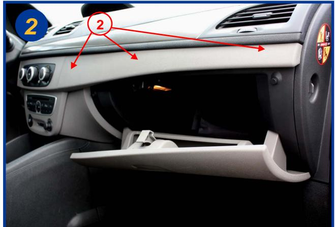
Ouvrir la boîte à gants et déclipser le bandeau supérieur du tableau de bord (2)
