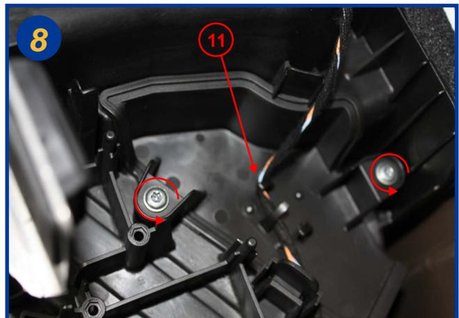
Dévisser les 2 vis d'ouverture du boîtier de filtre, écarter auparavant la connectique qui se trouve sur le couvercle (11).
