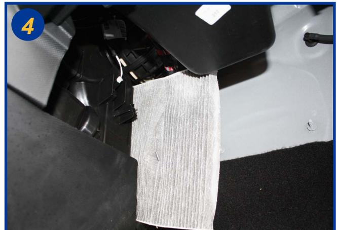
Extraire l'élément usagé en le déformant, procéder à son remplacement. Le remontage s'effectue dans l'ordre inverse du démontage.
