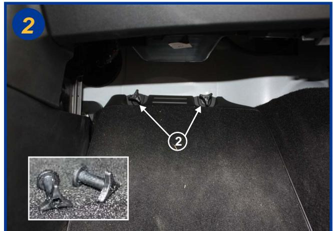
Dévisser les 2 écrous papillons spécifiques (2) situés sous la boîte à gants (détail des écrous dans l'encadré). Retirer ensuite la plaque repose-pieds en totalité.
