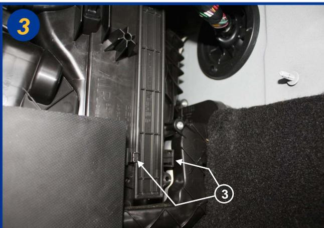
Ouvrir le boîtier filtrant en exerçant une pression sur les 2 pattes plastique (3). Retirer le couvercle.
