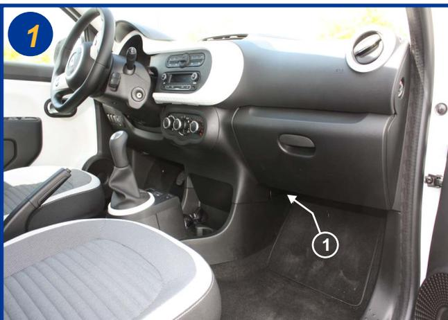
Le filtre habitacle est situé à l'intérieur du véhicule, côté passager sous la boîte à gants (1).
