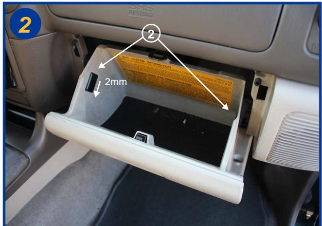
Retirer les deux butées de boîte à gants (2) : pour cela les pousser dans le sens des flèches pour qu'ils soient libres et les retirer.
