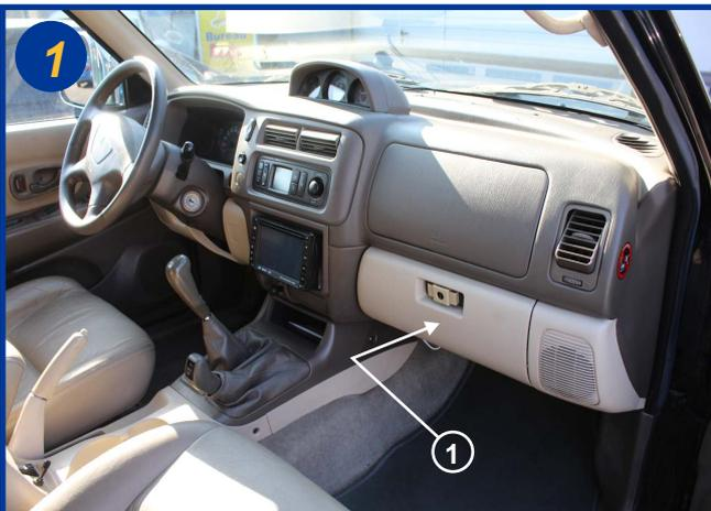
Les filtres d'habitacle sont situés à l'intérieur du véhicule coté passager derrière la boîte à gants (1). Ouvrir la boîte à gants.
