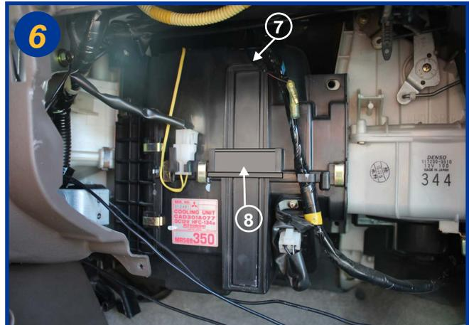
Ouvrir le boîtier filtrant (7) et sortir les deux filtres usagés e faisant coulisser le loquet plastique (8).
