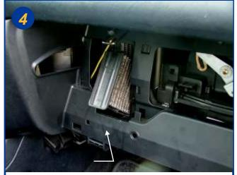
Puis le deuxième en le soulevant par le dessous (voir flèche). Les remplacer. Le remontage s'effectue dans l'ordre inverse du démontage.
