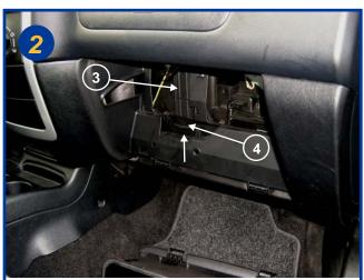
Les 2 filtres sont placés I 'un sur I 'autre (voir flèche 3) faire coulisser I 'agrafe de maintien (4) dans le sens de la flèche et la retirer.
