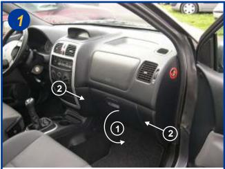
Les filtres d'habitacle sont situés à l'intérieur du véhicule, derrière la boîte à gants. Ouvrir celle-ci et presser sur les flancs pour la retirer (voir flèche 1 et flèche 2).
