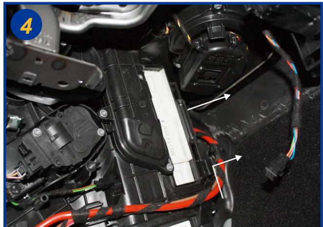
Sortir les éléments filtrants usagés, l'un après l'autre dans le sens des flèches. Le remontage s'effectue dans l'ordre inverse du démontage.
