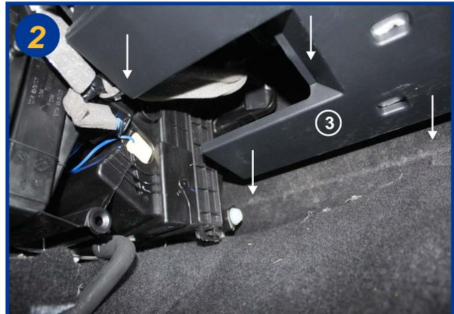
Dégrafer une fois encore le carter (3) sous la boîte à gants et le retirer également.
