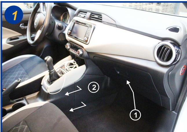
Le filtre d'habitacle est situé à l'intérieur du véhicule, coté passager sous la boîte à gants coté console (1). Dégrafer le carter plastique (2) puis le retirer dans le sens de la flèche.
