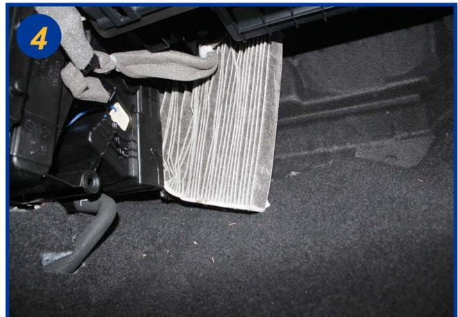
Extraire l'élément filtrant usagé en le déformant. Le nouvel élément sera compressé en accordéon pour l'insérer dans le boîtier. Le remontage s'effectue dans l'ordre inverse du démontage.
