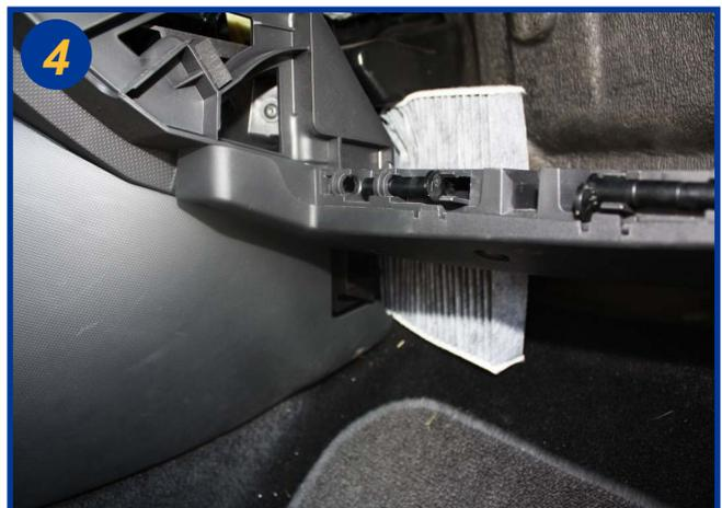
L'entrée du climatiseur étant plus petite que le filtre, le nouveau filtre devra également être déformé.
