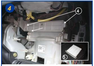
Exercer une traction sur le tiroir du filtre afin de le sortir (4), extraire l'élément usagé de son cadre et le remplacer (5). Le remontage s'effectue dans l'ordre inverse du démontage.
