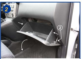
Ouvrir la boîte à gants et désolidariser l'axe de retenue (2), presser fortement sur les flans dans le sens des flèches afin de basculer la boîte vers le bas.
