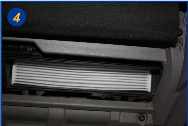
L'élément filtrant est placé verticalement, l'extraire par le bas.
