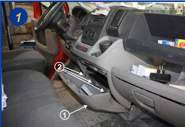
Le filtre d'habitacle est situé à l'intérieur du véhicule derrière la boîte à gants au centre (1).
