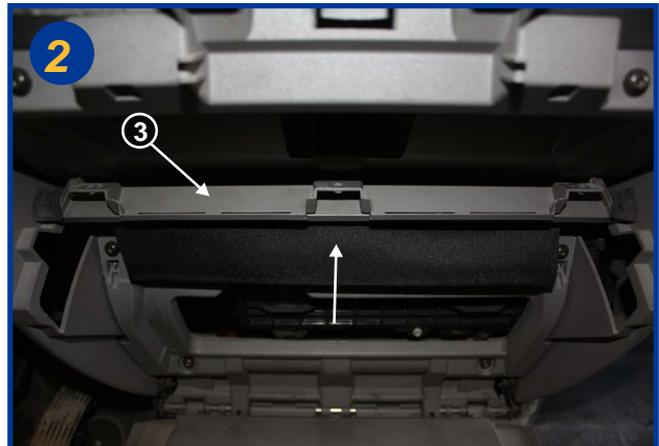
Faire basculer la boîte à gants sur le plancher après avoir soulevé la capote (3), placer l'ensemble sur le dessus pour avoir accès au boîtier filtrant.
