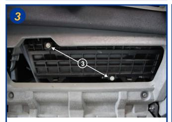
Dévisser les 2 vis tête hexagonale de 5 mm (3) et retirer le couvercle du boîtier filtrant. Retirer l'élément filtrant usagé.
