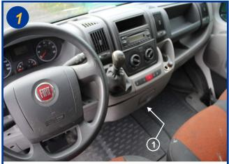
Le filtre d'habitacle est situé à l'intérieur du véhicule, au centre derrière la boîte à gants (1). Ouvrir la boîte à gants.
