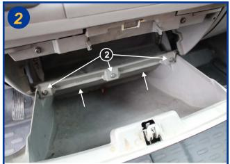
Dévisser les 3 vis torx T20 (2) puis soulever la barrette plastique dans le sens des flèches. Rabaisser la boîte à gants jusqu'au plancher.
