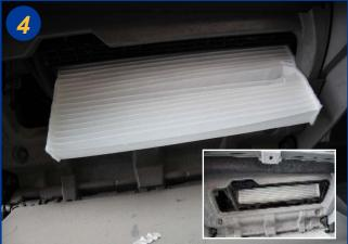
Replacer un élément neuf en le déformant légèrement pour qu'il puisse rentrer et prendre sa place (voir encadré). Le remontage s'effectue dans l'ordre inverse du démontage.
