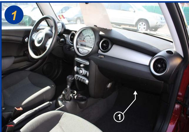
Le filtre d'habitacle est situé à l'intérieur du véhicule, coté passager sous la planche de bord (1).
