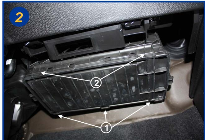
Agir sur les 2 fermetures (2) pour ouvrir le boîtier filtrant son couvercle possède une charnière en position arrière (3).
