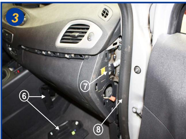
Dégrafer le flan (6) coté console centrale, dévisser la vis torx (T20)(7) et retirer sur une partie le joint (8) d'étanchéité de la portière.
