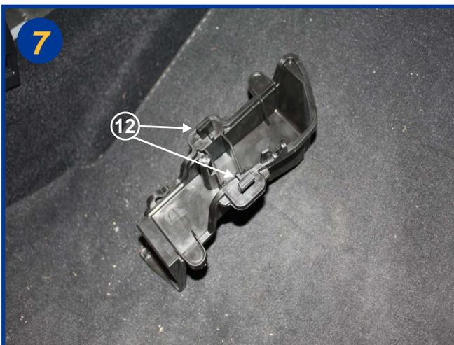
Détail du couvercle du boîtier filtrant, tirer sur les 2 poignées pour le retirer (12).
