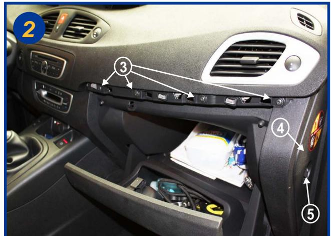
Dévisser les 4 vis torx (T20) (3). Dégrafer ensuite le flan (4) et déconnecter le bouton de désactivation de l'airbag (5).
