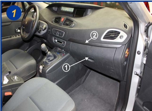
Le filtre d'habitacle est situé à l'intérieur du véhicule, coté passager, derrière la boîte à gants (1). Ouvrir la boîte à gants et retirer le bandeau (2), celui-ci est agrafé, il faut tirer dessus.
