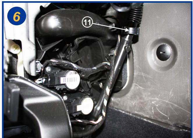
Ouvrir le collier (11) et mettre sur le côté la durite plastique et la connectique. Le boîtier filtrant est accessible.
