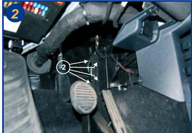
Ouvrir le boîtier filtrant en agissant sur les pattes plastiques de fermeture (2).
