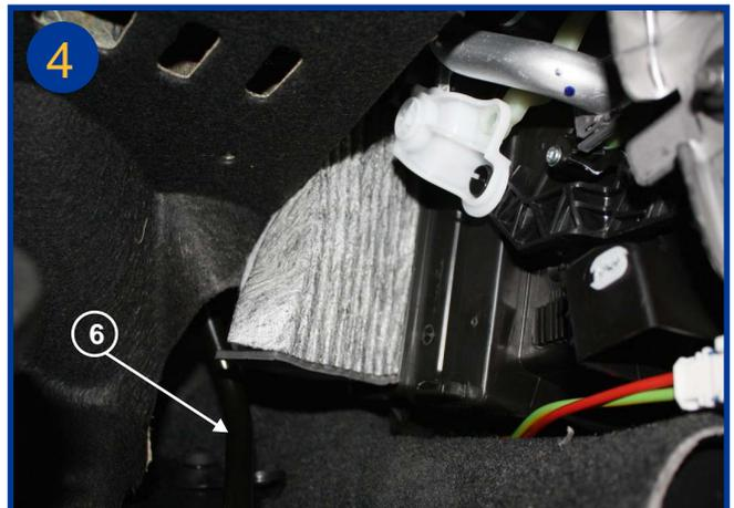
Extraire l'élément filtrant usagé et procéder à son remplacement, il est nécessaire de garder appuyé la pédale d'accélérateur pour retirer le filtre (6).
