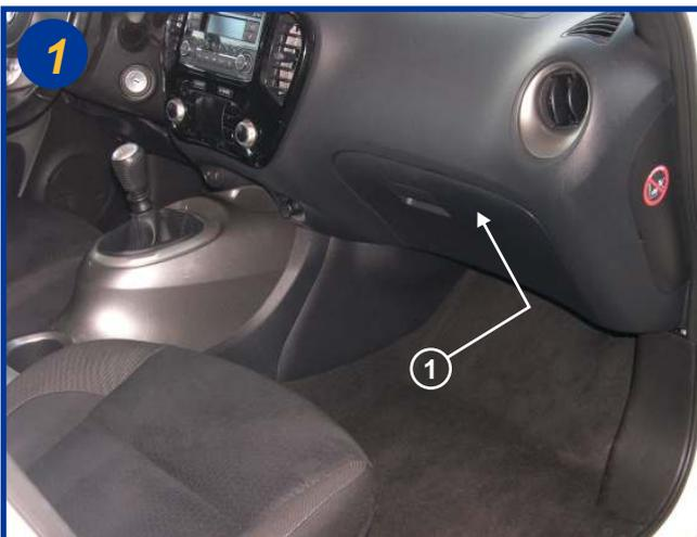
Le filtre d'habitacle est situé à l'intérieur du véhicule, coté passager derrière la boîte à gants, coté console centrale (1).
