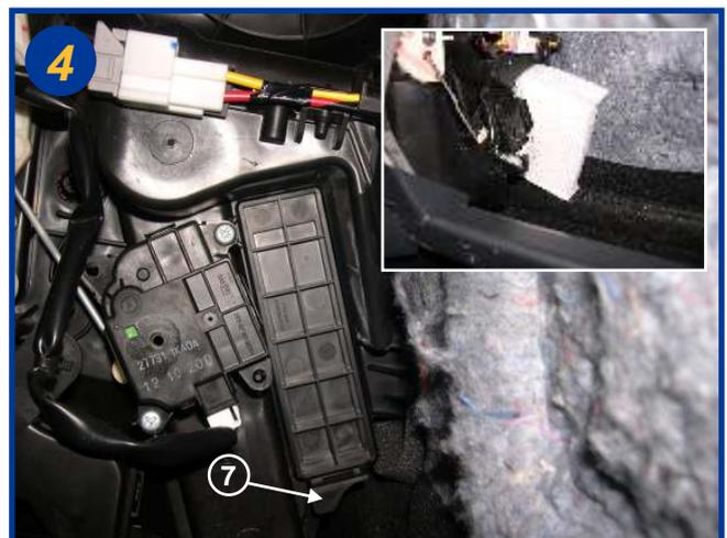
Repérer le couvercle du boîtier filtrant et l'ouvrir par le dessous (7). Retirer le filtre usagé en le déformant. Le remontage s'effectue dans l'ordre inverse du démontage.
