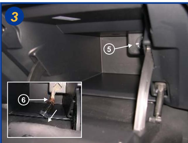
Mettre le commutateur Airbag sur la position off (5), le sortir de son logement (encadré) et le déconnecter en retirant la cosse (6). Extraire dans sa totalité le bloc boîte à gants.
