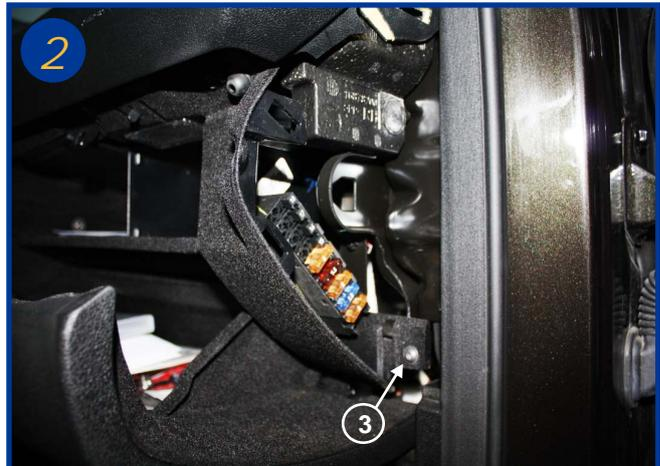
Ouvrir la boîte à gants, dégrafer le carter (2) (1ère photo) et le retirer totalement. Dévisser la vis Torx T20 (3).
