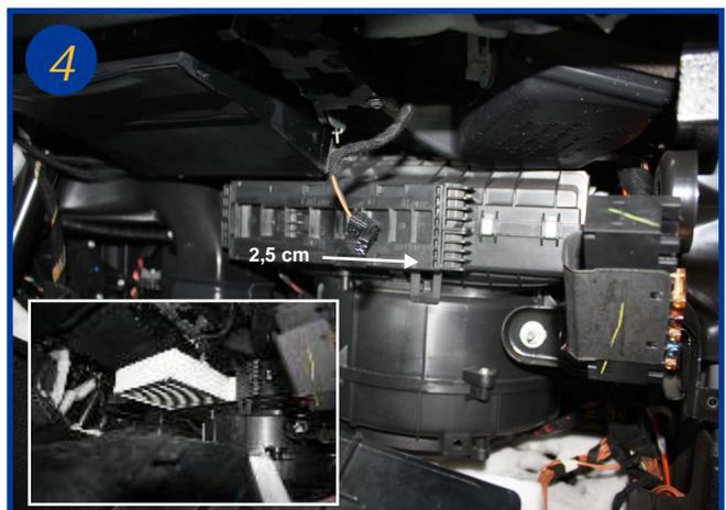
Pour ouvrir le boîtier filtrant, pousser le couvercle de 2,5 cm vers la droite. Remplacer les 2 filtres (encadré). Le remontage s'effectue dans le sens inverse du démontage.
