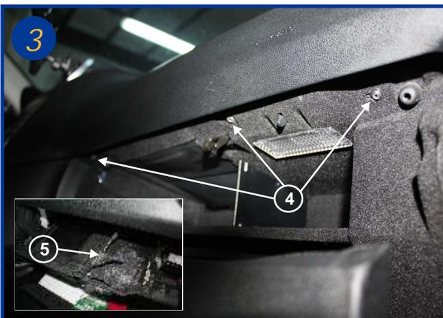
Dévisser les 3 vis Torx T20 (4) et descendre le bloc boîte à gants partiellement. Débrancher la connectique du plafonnier (5) (encadré) et descendre complètement le bloc boîte à gants.
