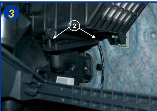
Agir sur les 2 fermetures du boîtier filtrant (devant et derrière) (2) et extraire le couvercle du boîtier filtrant.
