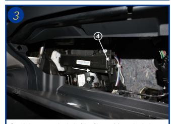
Ouvrir le couvercle du boîtier filtrant (4) par la droite et retirer le.
