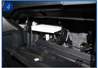
Sortir I 'élément filtrant usagé de son logement et procéder à son remplacement. Le remontage s 'effectue dans I 'ordre inverse du démontage.
