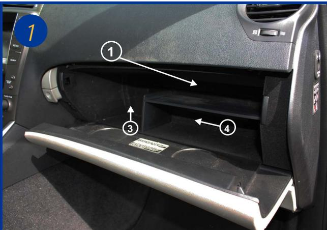
Le filtre d'habitacle est situé à l'intérieur du véhicule, côté passager, dans le fond de la boîte à gants (1). Retirer la séparation plastique dans le sens des flèches (3 puis 4).
