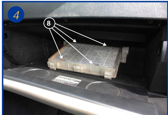
Extraire le cadre et changer le filtre usagé, le filtre devra être remplacé sous les 4 ergots (8). Le remontage s'effectue dans l'ordre inverse du démontage.
