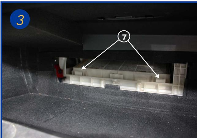
Agir sur les 2 fermoirs (7) et soulever le cadre et son élément filtrant.
