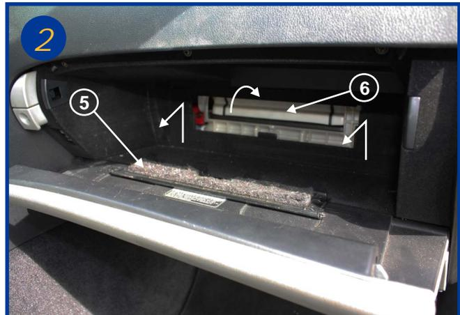
Retirer le couvercle du boîtier filtrant (5) en soulevant légèrement celui-ci et en tirant (voir flèche). Soulever le capot (6).
