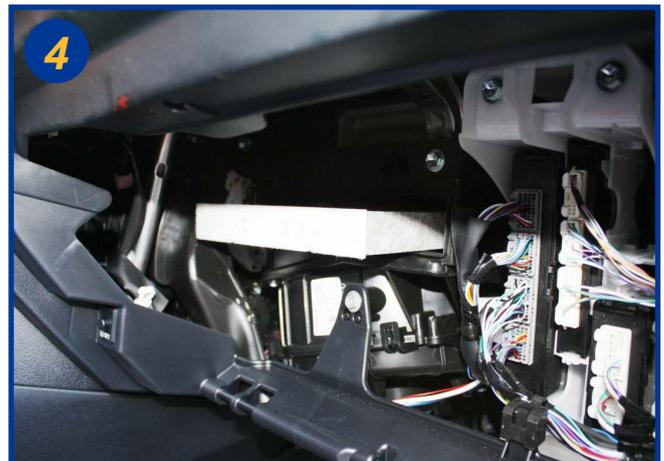
Extraire l'élément filtrant de son logement et procéder à son remplacement. Le remontage s'effectue dans l'ordre inverse du démontage.
