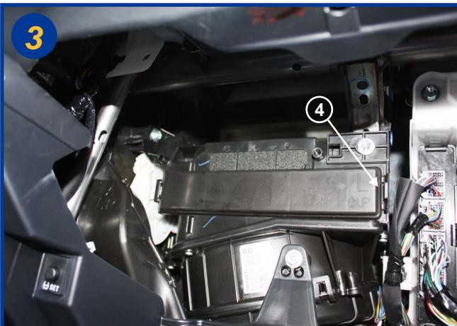
Ouvrir le boîtier filtrant à l'aide du fermoir situé à droite du couvercle (4), ce couvercle étant articulé à gauche. Retirer le couvercle.
