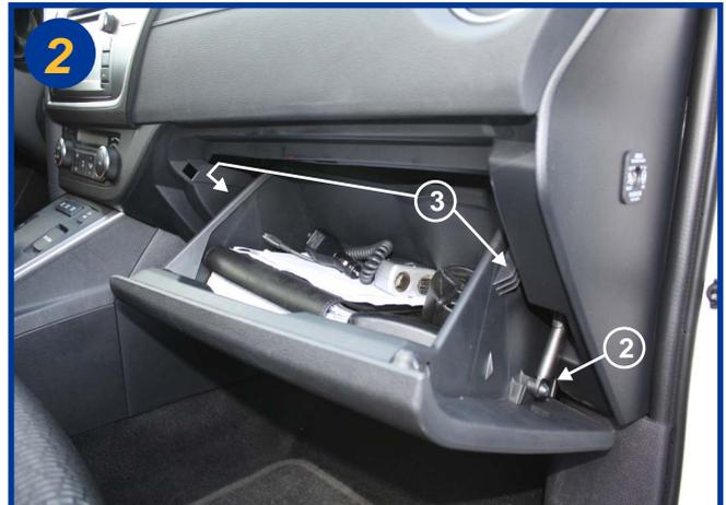
Désaccoupler l'amortisseur d'ouverture de boîte (2), puis presser sur les flancs du tiroir pour dégager les arrêteurs (3), basculer le tiroir vers le bas pour le désolidariser et le retirer totalement.
