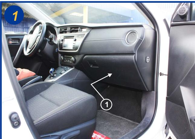
Le filtre d'habitacle est situé à l'intérieur du véhicule, coté passager derrière la boîte à gants (1). Ouvrir la boîte à gants.
