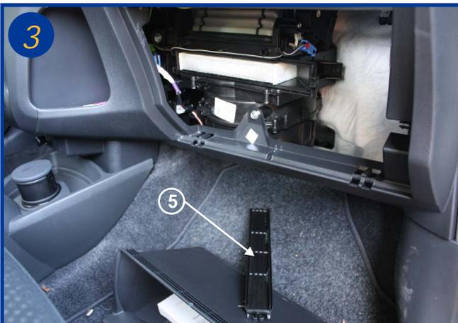
Retirer le couvercle (5) et extraire l'élément filtrant usagé.
