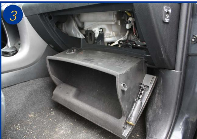
Ouvrir le couvercle du boîtier filtrant en faisant pression sur le coté droit (3) retirer le couvercle.
