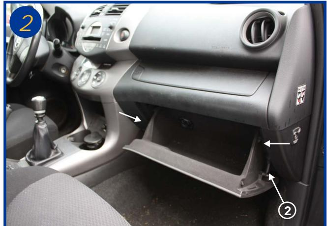
Ouvrir la boîte à gants, appuyer sur les fancs du tiroir afin de dégager les arrêteurs (voir flèche) et retirer le vérin de retenue (2).
