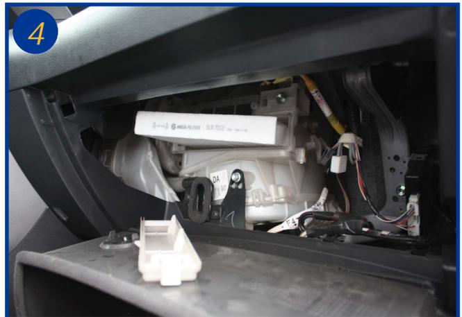
Extraire l'élément filtrant usagé et le remplacer.
