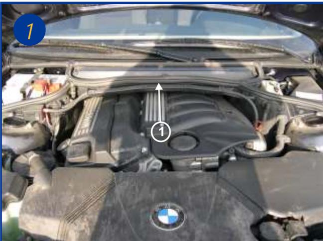
L'élément filtrant est situé devant la baie du pare brise sous le capot moteur au centre (voir flèche 1)
