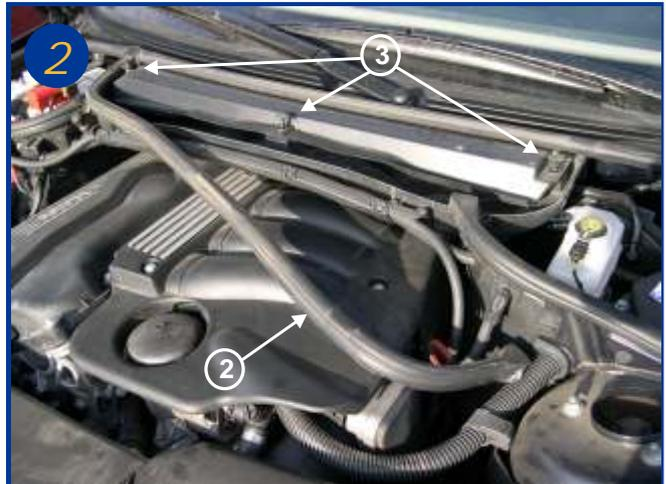
Retirer une partie du joint d'étanchéité du compartiment moteur (voir flèche 2).
