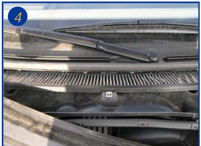
Repositionner le nouvel élément filtrant.
