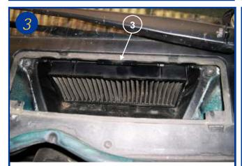
Les filtres sont directement accessible, il suffit de déboiter le filtre dans sa partie supérieure (voir repère 3) et le tirer vers soi.
