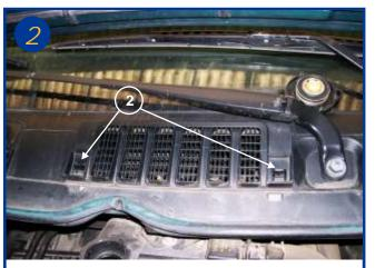
Les 3 logements sont basés sur le même principe de démontage, actionnez les 2 loquets vers le bas pour retirer la grille plastique (voir repère 2).
