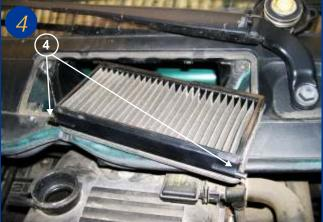
Les filtres sont munis de petits axes (repère 4), afin de les positionner correctement. cette action est à renouveler sur les 3 logements. Le remontage s'effectue dans l'ordre inverse du démontage.
