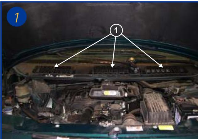
Les filtres d'habitacle sont situés sous la baie du pare-brise (1 central et 2 latéraux)(voir repère 1). Il n'est pas nécessaire d'ouvrir le capot moteur pour remplacer les filtres.
