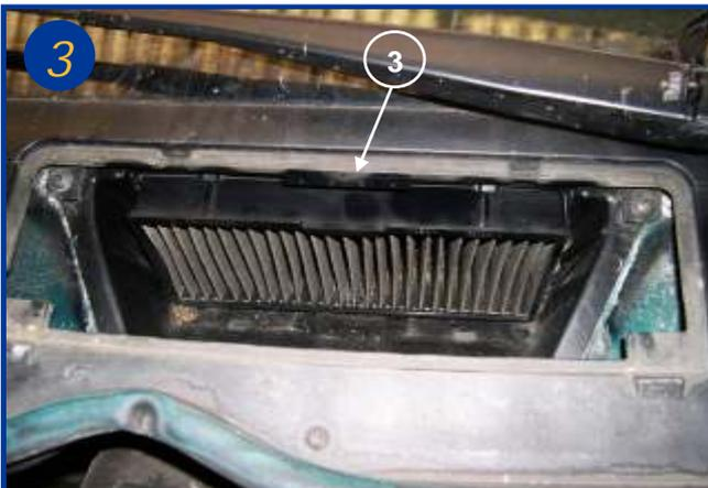
Les filtres sont directement accessible, il suffit de déboîter le filtre dans sa partie supérieure (voir repère 3) et le tirer vers soi.
