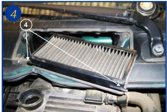
Les filtres sont munis de petits axes (repère 4), afin de les positionner correctement. cette action est à renouveler sur les 3 logements. Le remontage s'effectue dans l'ordre inverse du démontage.
