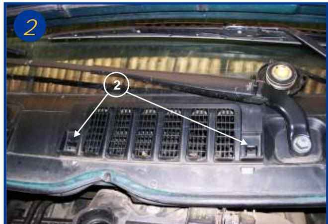
Les 3 logements sont basés sur le même principe de démontage, actionnez les 2 loquets vers le bas pour retirer la grille plastique (voir repère 2).
