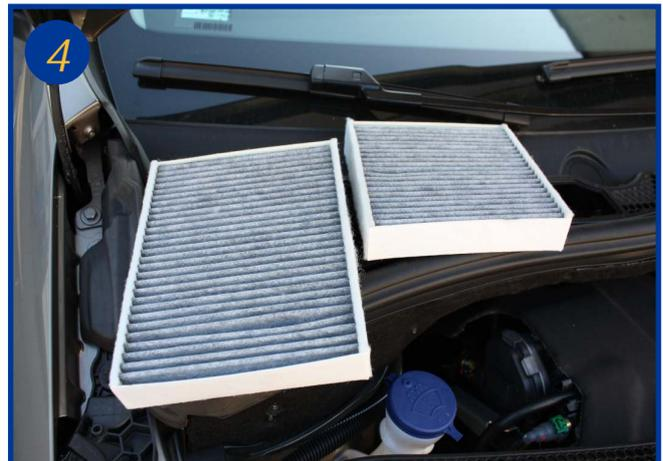
Extraire les 2 éléments filtrants usagés et les remplacer le remontage s'effectue dans l'ordre inverse du démontage.
