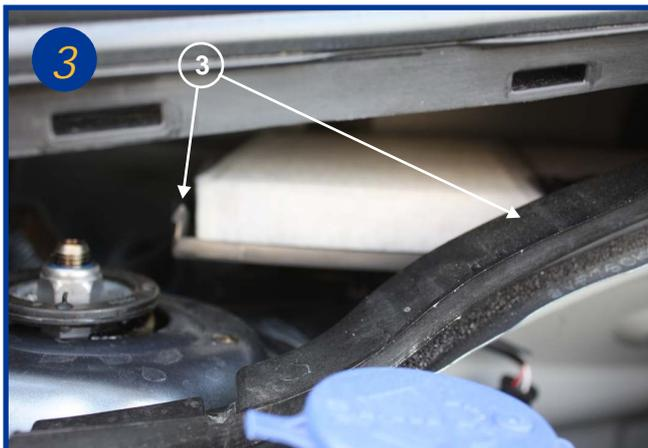
Basculer la trappe d'ouverture en actionnant les deux loquets plastiques aux extrémités (3).
