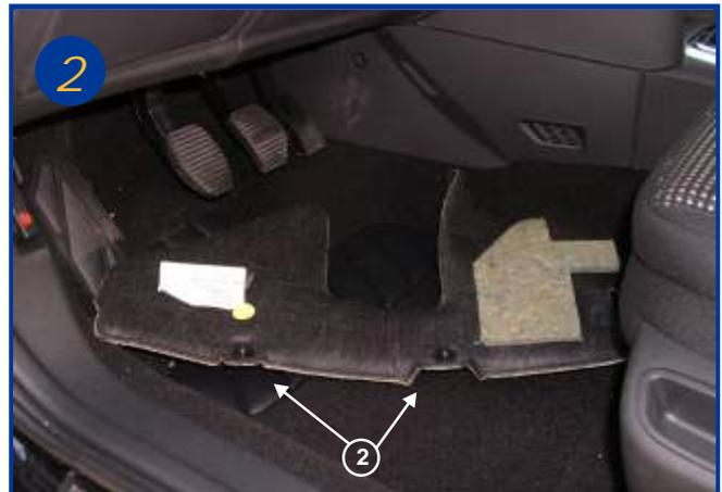
Retirer le cache de protection sous la colonne de direction en tirant sur les deux clips (voir flèche 2).
