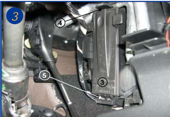
Localiser le couvercle du boîtier du climatiseur (3), soulever la patte de fermeture (flèche 4) et retirer le couvercle en le soulevant de son encoche (flèche 5).
