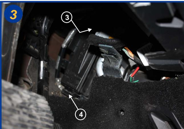
Ouvrir le boîtier filtrant par le haut (3) et retirer son couvercle (articulé sur le bas) (4).
