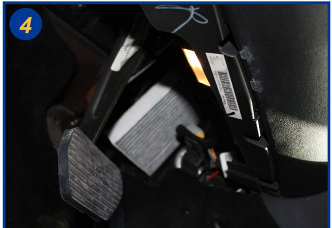
Appuyer sur la pédale d'accélérateur pour dégager le filtre usagé et procéder à son remplacement. Le remontage s'effectue dans l'ordre inverse du démontage.
