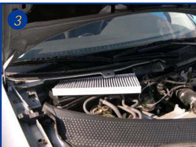
Positionner le nouvel élément dans son cadre, veiller à ce que les deux premiers plis de part et d'autre de l'élément soient insérés dans les nervures du cadre.
