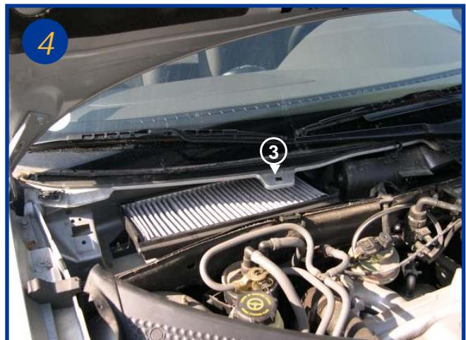
Une fois l'élément remonté dans son cadre, remonter la demi-grille d'aération en veillant à ce que sa nervure soit positionnée sous le tablier métallique et le clips plastique dans son logement (3).
