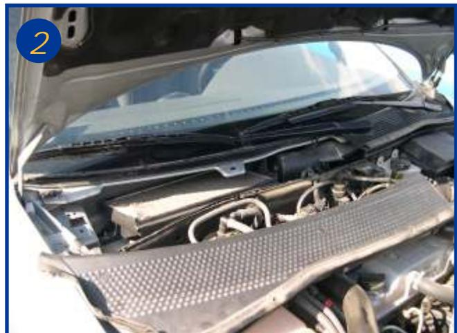
Extraire l'élément filtrant usagé et le remplacer.
