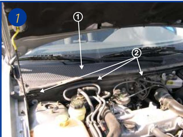
L'élément filtrant est situé sous le capot moteur sur la baie du pare brise coté passager (voir flèche 1). Retirer la demi-grille d'aération en actionnant les 3 clips de fermeture (voir flèche 2).
