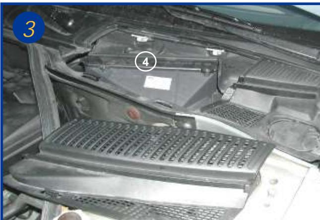
Retirer le couvercle du climatiseur maintenue par 2 vis (4).
