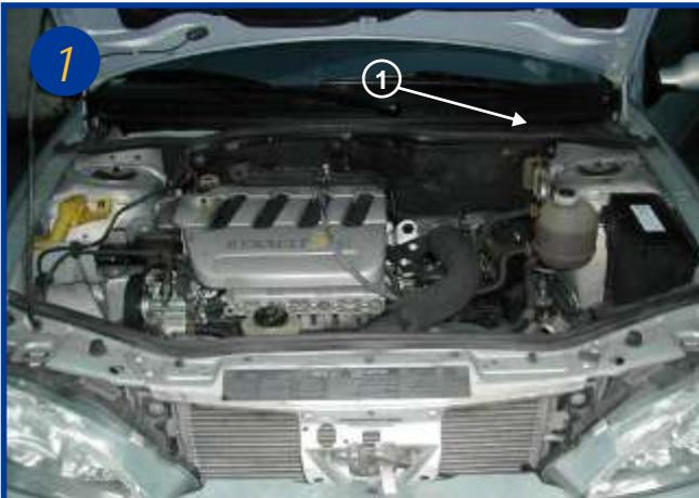
L'élément filtrant est situé sous le capot moteur devant la baie du pare brise coté conducteur (repère 1). Ouvrir le capot moteur et localiser le boîtier du filtre a air d'habitacle.
