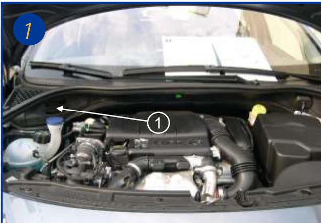
Le boîtier filtrant est situé sous le capot moteur, côté passager (voir flèche 1)
