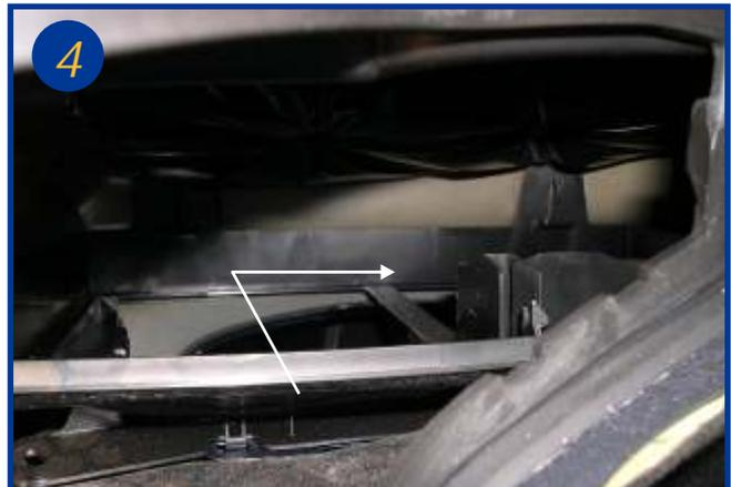
Replacer 2 filtres neufs, d'abord le plus petit puis le plus grand dans le sens de la flèche. Refermer le loquet puis réajuster la trappe de fermeture du boîtier.
