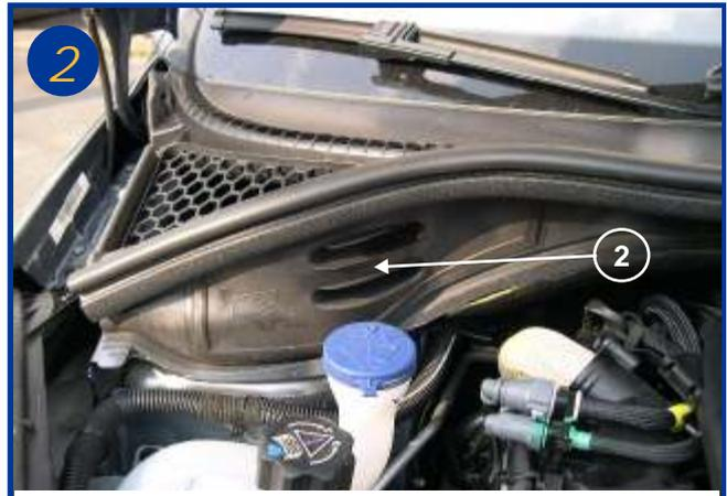
Les 2 filtres sont logés l'un à côté de l'autre derrière la trappe ci-dessus (voir flèche 2).
