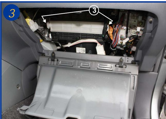
Ouvrir le couvercle du boîtier filtrant en agissant sur les 2 pattes de fermeture (3) et sortir le cadre et son filtre.
