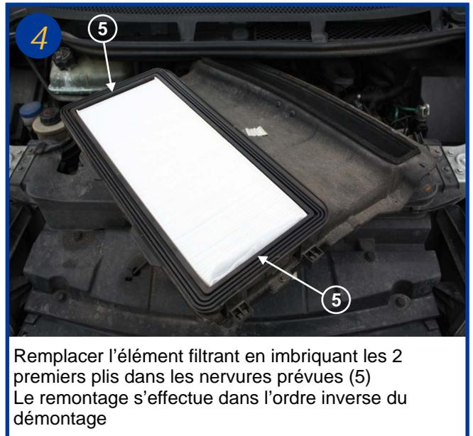
Remplacer l'élément filtrant en imbriquant les 2 premiers plis dans les nervures prévues (5)
