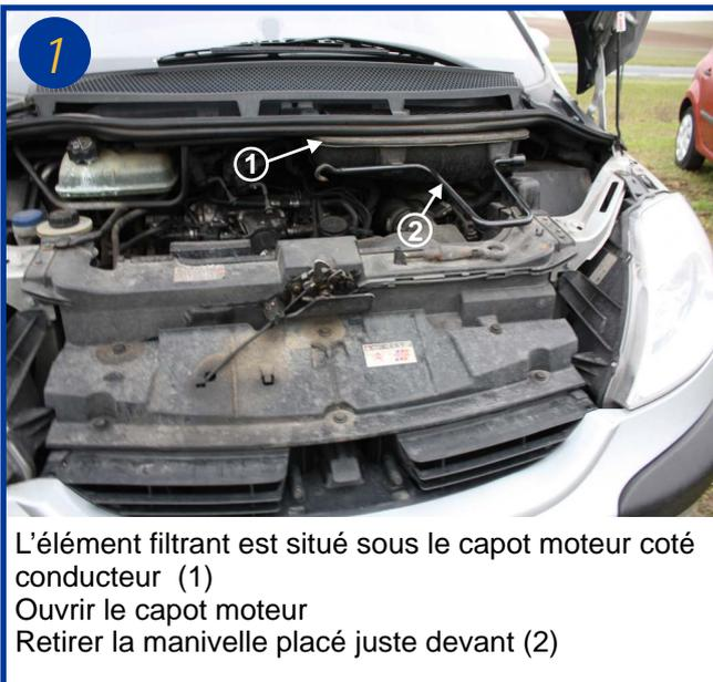
L'élément filtrant est situé sous le capot moteur coté conducteur (1)
