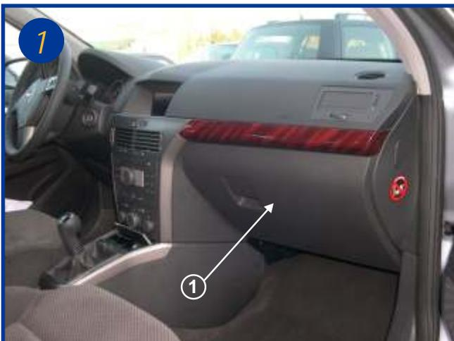
L'élément filtrant est situé dans l'habitacle du véhicule coté passager derrière la boîte à gants. (Flèche 1).
