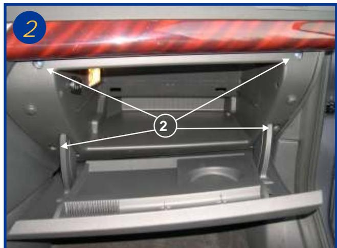
Ouvrir la boîte à gants, dévisser les quatre vis cruciformes fixant celle-ci (voir flèche 2) puis la retirer. Veiller à débrancher les 2 cosses électriques d'alimentation de l'éclairage de la boîte à gants.
