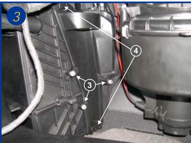
Dévisser ensuite les 3 vis fixant le couvercle du boîtier du filtre d'habitacle (flèche 3), retirer ce couvercle en faisant pression sur les pattes d'encliquetage situées aux deux extrémités de celui-ci (flèche 4).
