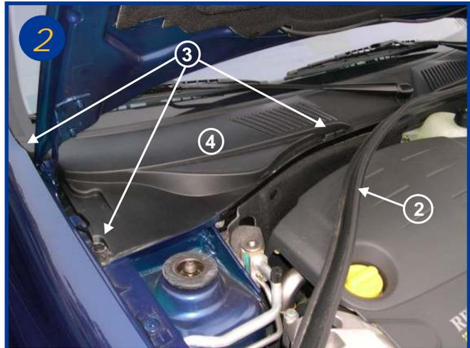
Retirer sur la moitié de sa longueur, le joint d'étanchéité du compartiment moteur (flèche 2). Déclipser le cache en matière plastique (flèche 3)
