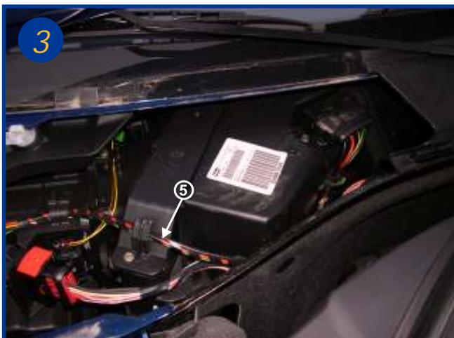
Dévisser le couvercle plastique, pour cela retirer le cable de son support et enlever la vis de maintien (voir flèche 5).
