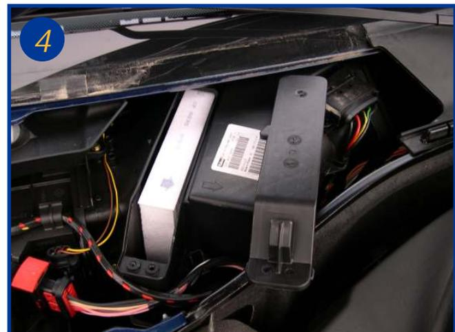
Extraire l'élément filtrant usagé, le remplacer.
